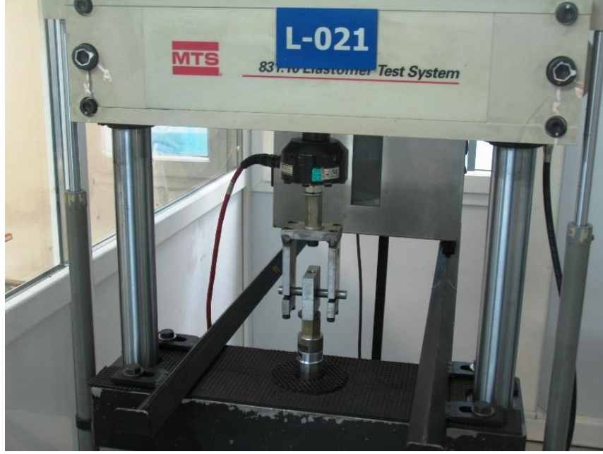
Şekil 2.9 MTS 831.10 Elastomer Test Sistemi
